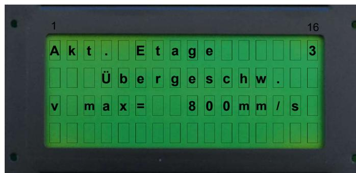
Im Display der Steuerung wird in der obersten Zeile die aktuelle Etage angezeigt. In der 2. Zeile wird der aktuelle Steuerungszustand angezeigt. In der 3. Zeile wird die Maximal erreichte Geschwindigkeit angezeigt.
