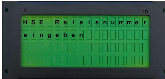
Hier muss als nächstes eingegeben werden, welches Relais der HSE nach Fahrtende nicht abgeschaltet werden soll. Die Auswahl erfolgt durch Betätigung einer Zifferntaste.
