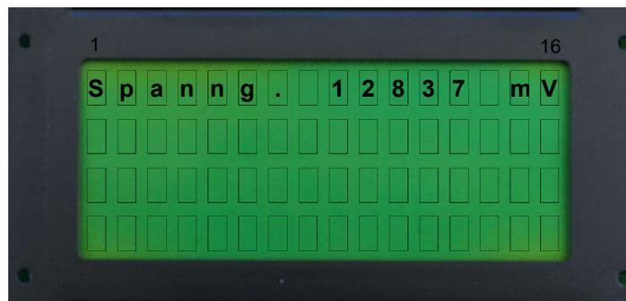
Im Display wird die unter Last gemessene Spannung angezeigt. Bei einer Spannung kleiner 12000mV sollte die Batterie gewechselt. (12V mindestens 2,6AH)
