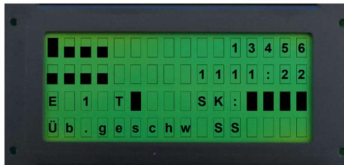
Nach dem Nothalt fährt der Aufzug zur nächstliegenden Etage und startet danach erneut. (Bei Hydraulikanlagen erfolgt erst eine Notabsenkung in die unterste Etage) Erst nach dem 3. Auftreten von „Übergeschwindigkeit“ geht der Aufzug komplett außer Betrieb. In der untersten Zeile im LCD-Display erscheint der Text „Üb.geschw.“ abwechselnd mit „!Defekt!“.
