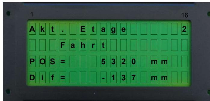
Im LCD-Display wird in der 3. Zeile die Position angezeigt, an der die Bremse abgeschaltet wird. In der 4. Zeile wird angezeigt, wie weit sich der Fahrkorb seit dem Abschalten der Bremse bewegt hat (nur bei digitaler Schachtkopierung).
