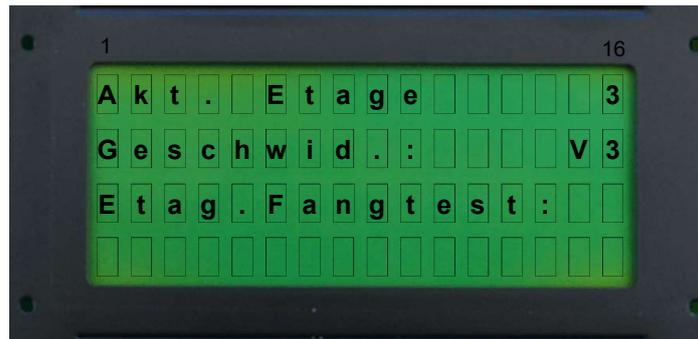
Die Steuerung erwartet die Eingabe mit welcher Geschwindigkeit und in welche Etage der Test durchgeführt werden soll. Mit den Pfeiltasten die Geschwindigkeit auswählen, V3 (Nenngeschwindigkeit) V2 ca. 0,5m/s und V1 ca. 0,1m/s. (V2 und V1 vorher überprüfen) Etage mit den Ziffern eingeben und->
