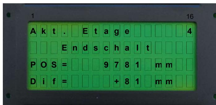
Im Display wird in der 3. Zeile die Position der obersten bzw. untersten Etage angezeigt. In der 4. Zeile wird angezeigt, um wie viel mm der Aufzug über die letzte Etage hinaus gefahren ist, Endschalterposition. (nur bei digitaler Schachtkopierung)
