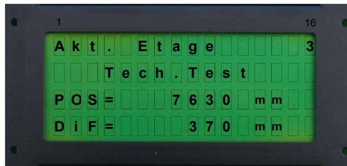
Im LCD-Display wird in der 3. Zeile die Position angezeigt an der der Test gestartet wird. In der 4. Zeile wird angezeigt wie weit sich der Fahrkorb bewegt hat.
