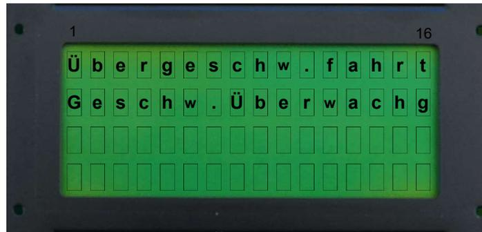
Mit dem Menüpunkt "Übergeschw.fahrt" wird Fang oder Rohrbruchsicherung getestet (siehe 6.1.3.1)
