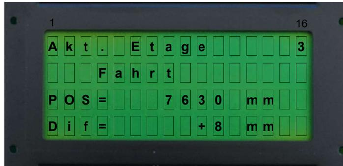
Im Display der Steuerung wird in der 3. Zeile die Startposition angezeigt, und in der 4. Zeile der Weg, wie weit sich der Aufzug eventuell mit geschlossener Bremse bewegt hat. (nur bei digitaler Schachtkopierung).
