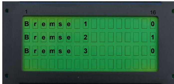
Die Steuerung öffnet die Bremse 1 und zeigt im Display rechts den Weg in mm an den sich die Kabine bewegt hat. Bremse 1 wird geschlossen und 1 Sekunde später wird Bremse 2 geöffnet und rechts angezeigt ob die Kabine sich bewegt. (sofern vorhanden wird danach der Test mit Bremse 3 durchgeführt)
