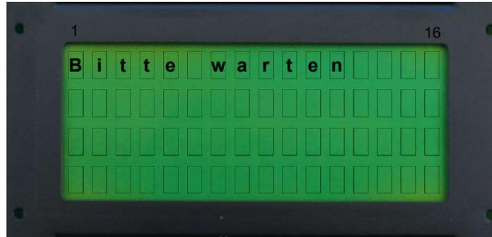
Die Steuerung überprüft ob die System Batterie noch ausreichend geladen ist um bei einem Stromausfall sicherzustellen, dass das Notlicht funktioniert und der Notruf abgesetzt werden kann.
