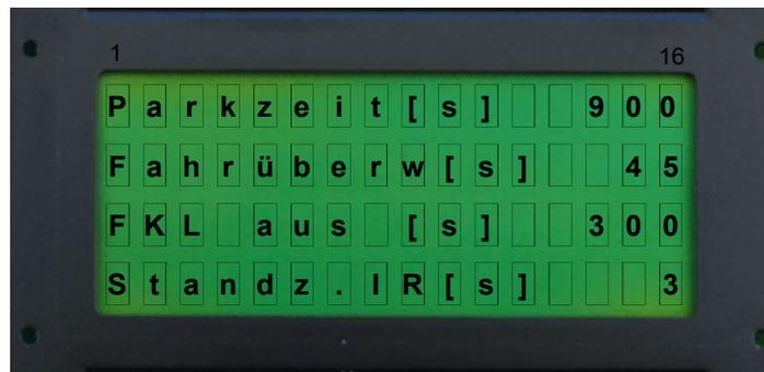
auf einen Wert gesetzt, der kleiner ist als die Zeit, die der Aufzug für die Fahrt zwischen 2 Etagen (Verlassen der einen Türzone und Einfahrt in die nächste Türzone) benötigt. Im Normalfall funktioniert eine Einstellung von 2s für diesen Test.
