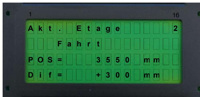
Beim Einfahren in die obersten bzw. untersten Etage verzögert der Aufzug, fährt dann mit Einfahrtsgeschwindigkeit bis in den Endschalter (abhängig von der Parametereinstellung „Allg. Parameter/Ob.Endsch. bzw. Unt.Endsch.“ wird eventuell auch „SK fehlt“) angezeigt.
