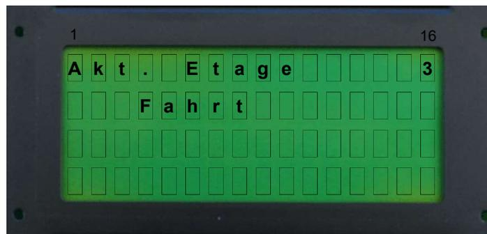
Nach Fahrtende wird das entsprechende Vorsteuerrelais nicht abgeschaltet. Im LCD-Display wird die aktuelle Etage sowie der Steuerungszustand angezeigt.
